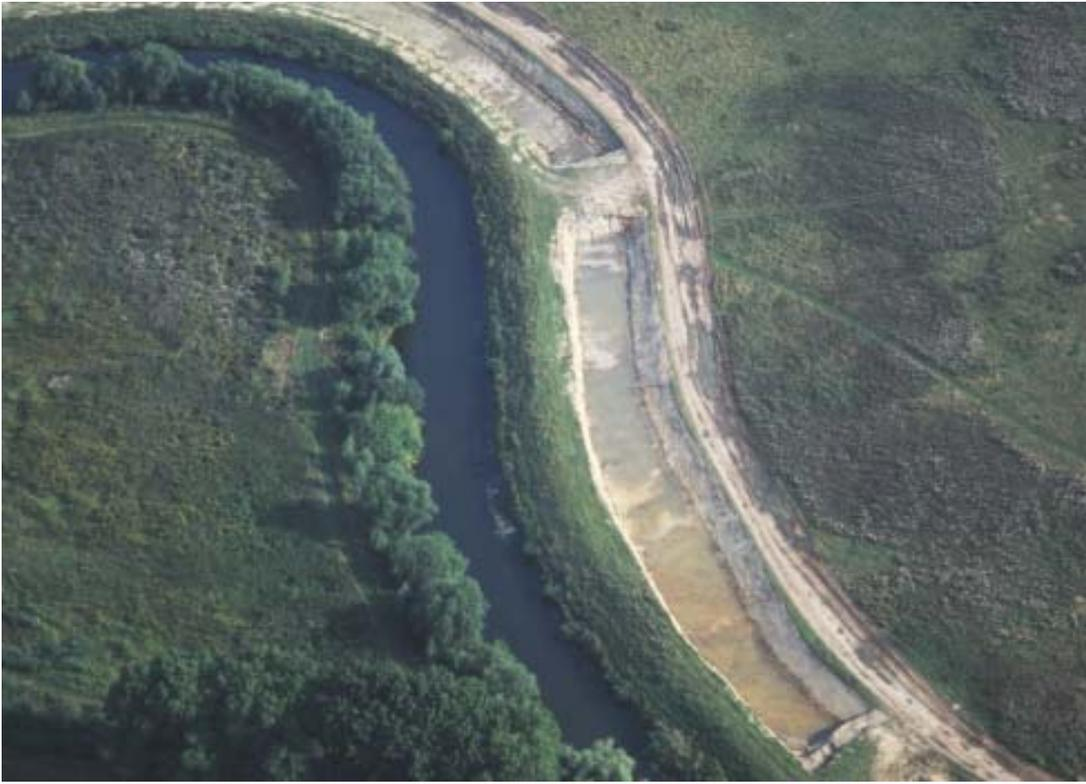
*Aus der Luft wird der Umfang der Baumaßnahmen deutlich: links die Lippe mit dem unverändert bleibenden Innenufer, rechts neben dem Fluß der Mitteldamm, der Verbreiterungsgraben und die Baustraße. Der größte Teil des Schutzgebietes blieb vom Baustellenverkehr unberührt*
